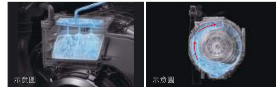
噴射水流清洗熱交換器。
